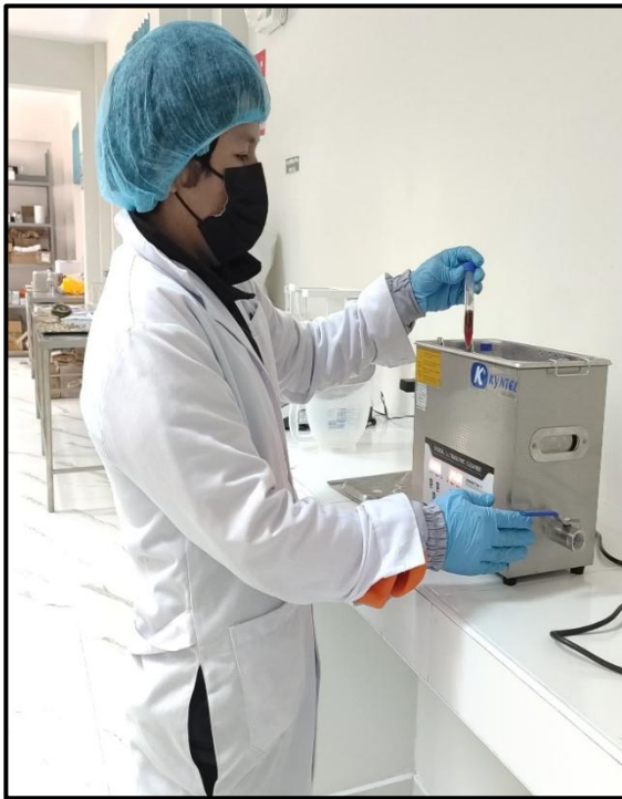
6. Proceso de extracción mediante baño de ultrasonido
