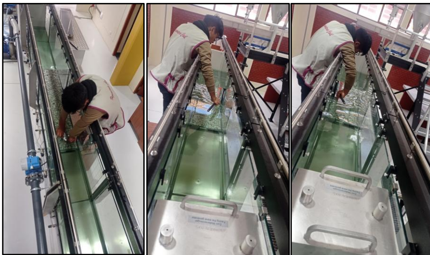
Figura A. 6: Instalación de fondo de grava en el canal hidráulico
