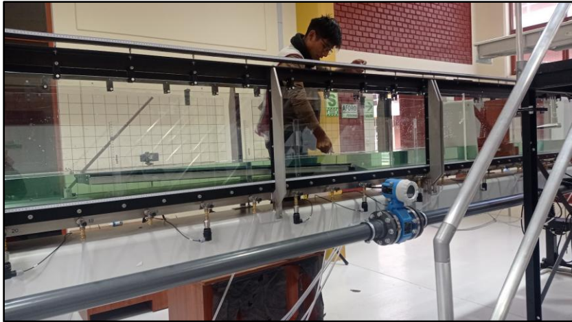
Figura A. 4: Instalación de fondo liso con pendiente en el canal hidráulico
