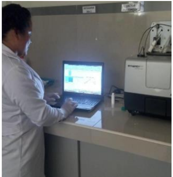
Fotografía 11: En el lector multimodal se midió los compuestos fenólicos a una absorbancia de 739 nm en muestras frescas y liofilizadas de las cuatro variedades.
