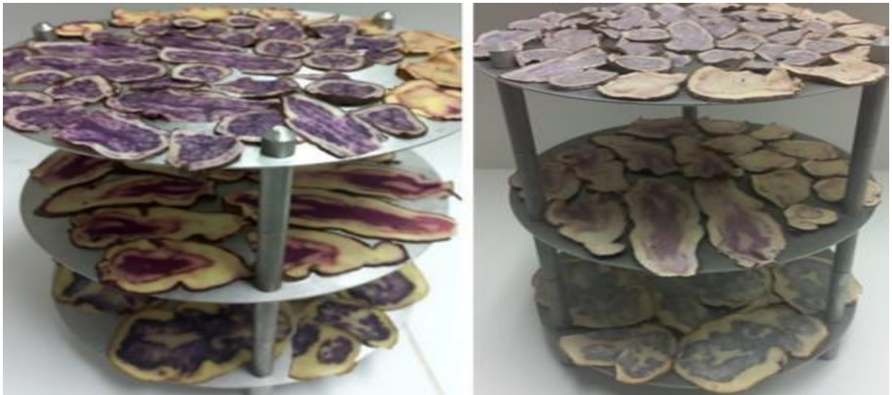
Fotografía 3: El proceso de la liofilización de los residuos de las papas nativas primero se pasó al lavado y desinfectado, seguido por el rallado y congelado
