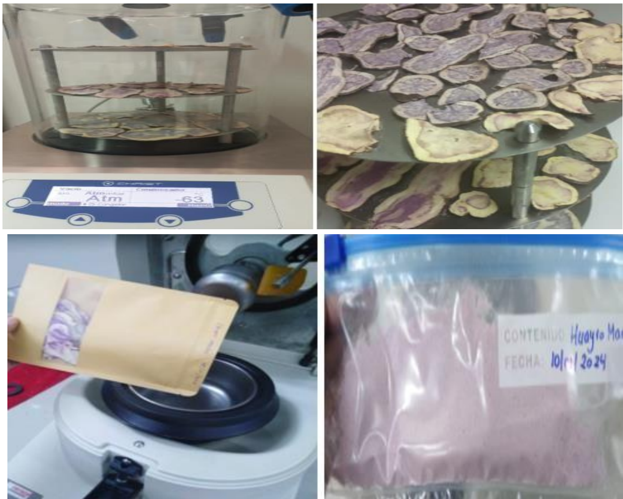
Fotografía 4: Los residuos de las papas nativas congeladas se sometieron a liofilización, luego se molieron y se empaquetaron
