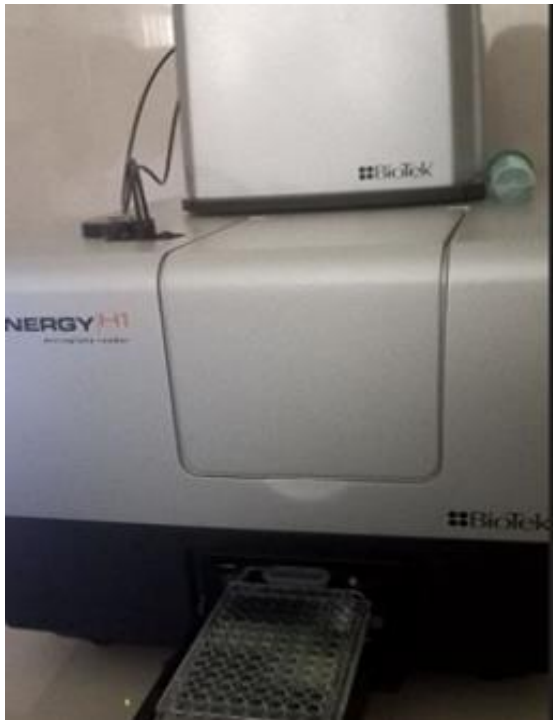
Fotografía 11: En el lector multimodal se midió los compuestos fenólicos a una absorbancia de 739 nm en muestras frescas y liofilizadas de las cuatro variedades.
