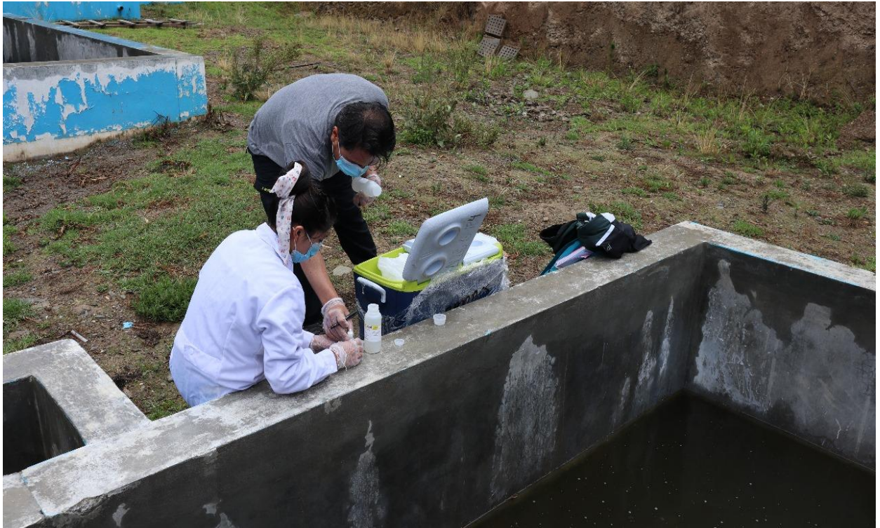
Figura 10: Recolección de muestra en los pozos de tratamiento
