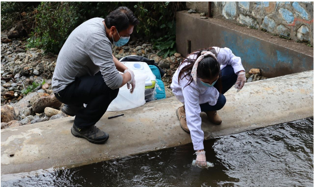
Figura 9: Recolección de muestra en el P-1 en la captación (rio)
