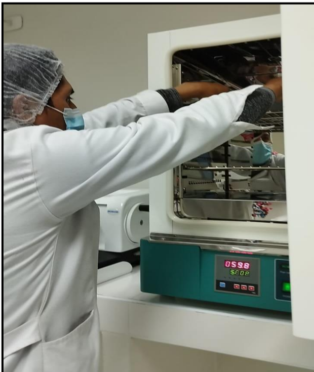
Fotografía 7. Secado a temperaturas de 50, 60, 70 y 80 °C
