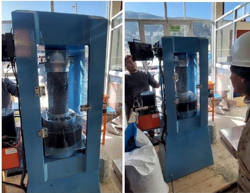
Ensayo de “Resistencia a la Compresión.
