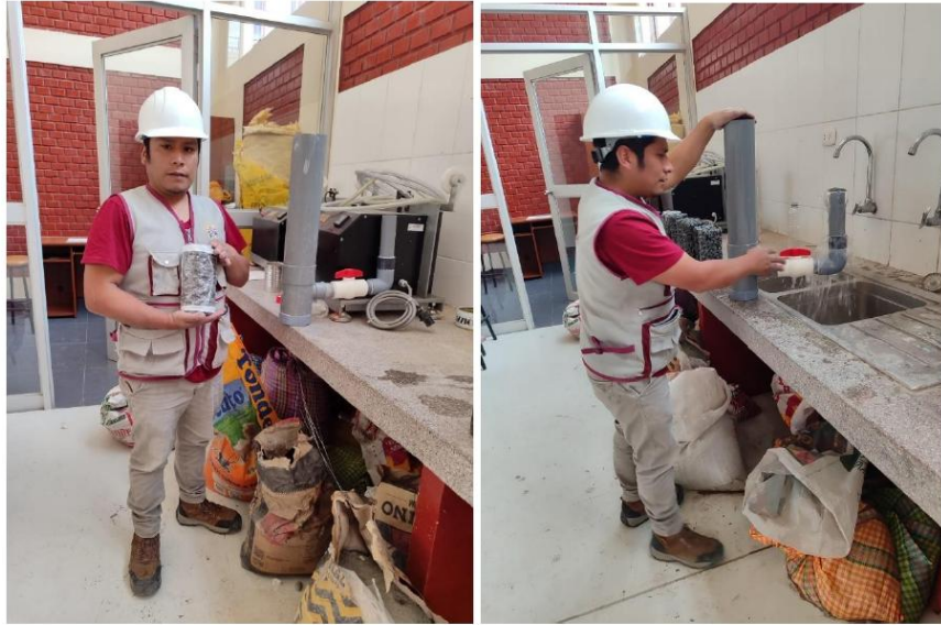
Ensayo de índice de infiltración (Permeabilidad).
