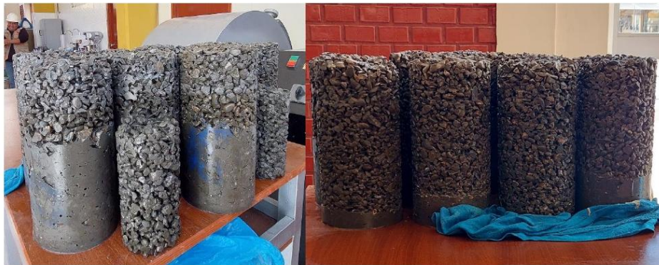
Pruebas de descarte de diseños: buscando la idónea relación a/c.
