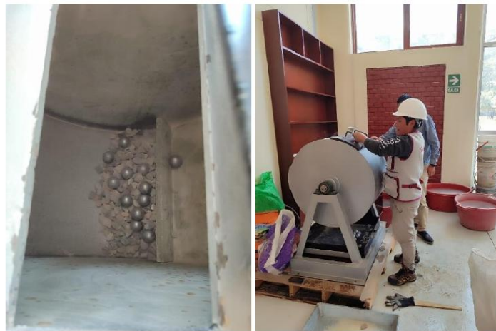
Verificación de material y carga abrasiva en la máquina los Ángeles”, Ensayo de Abrasión.
