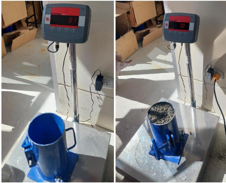
Pesado del molde: sin material y con material; para determinar peso unitario.
