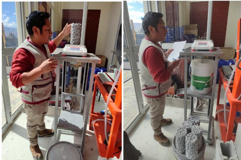
Pesado de muestra en Aire y en agua para su respectivo ensayo de P.U. y cantidad de vacíos.
