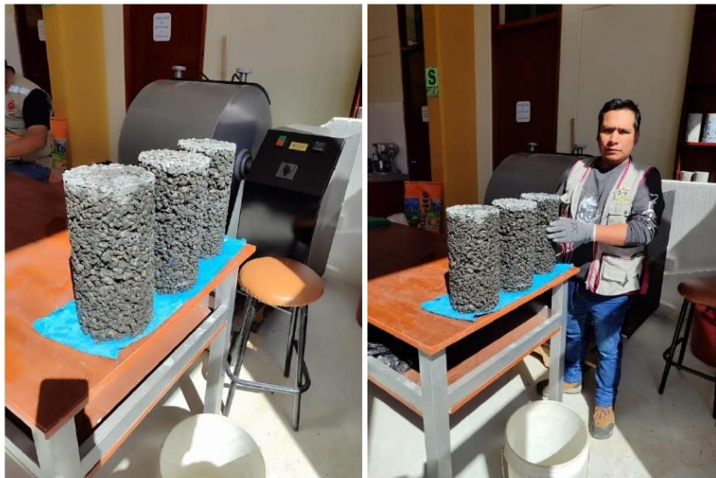
Preparación de las muestras para su respectivo pesado.
