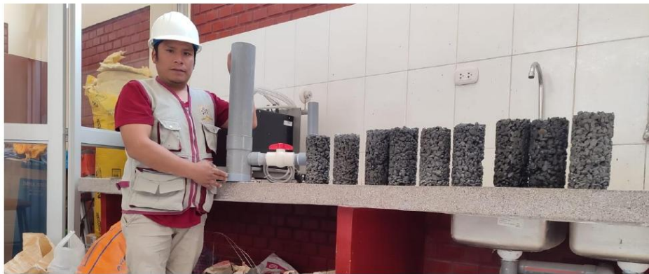
Preparación del permeámetro para el ensayo de Índice de infiltración.
