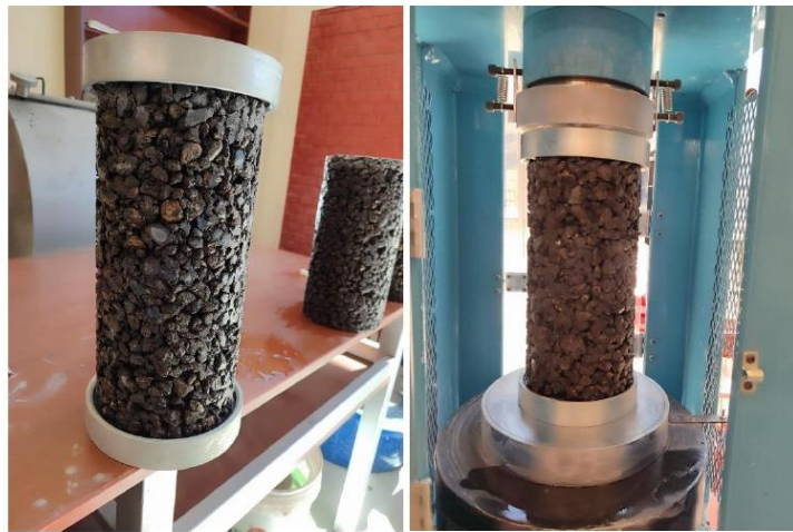
Colocado de anillos superior e inferior, y montaje en la maquina para su ensayo de compresión.
