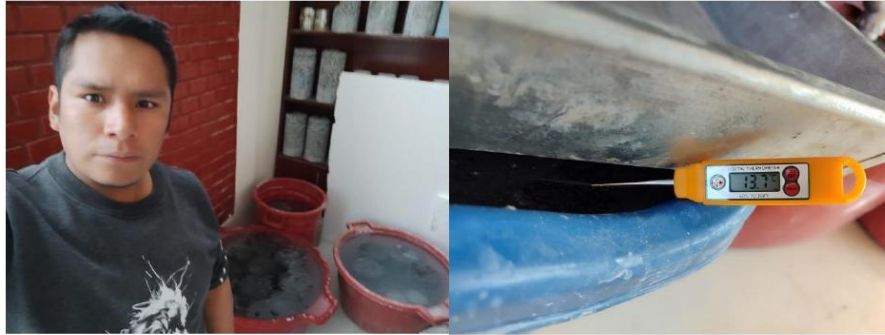
Curado de los diferentes diseños de mezcla y medición de la temperatura.
