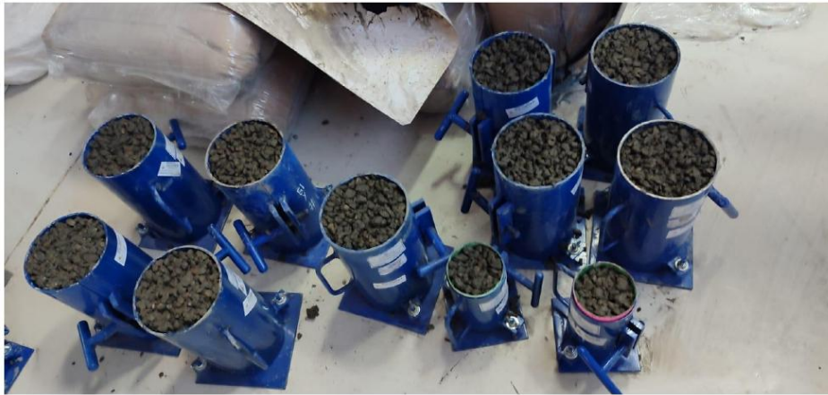
Preparado de los diseños con verificación de la relación a/c.
