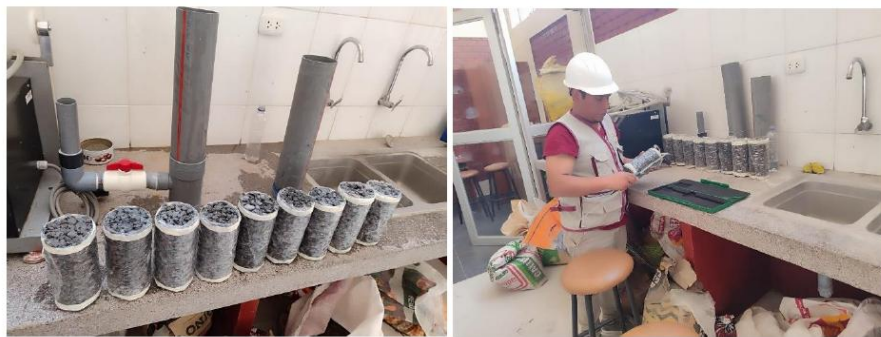
Forrado de muestras para evitar fuga durante el ensayo, mediciones de las muestras.
