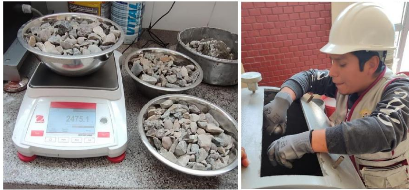
Pesado del agregado grueso, insertado de carga abrasiva “Ensayo los ángeles”.
