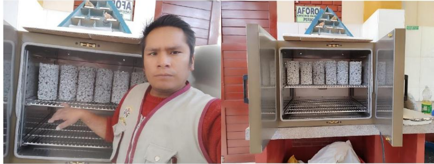
Secado de muestras en Horno a 110 C° durante 24 horas.
