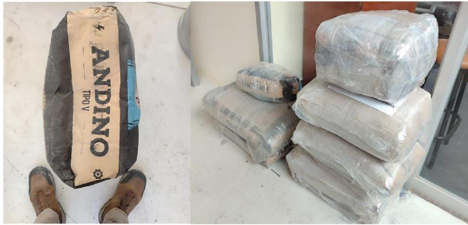
Almacenamiento del Cemento portland Tipo V y de Sika Fume.
