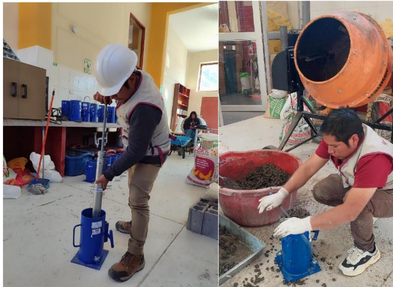
Compactado de muestra con el martillo Marshall estándar.
