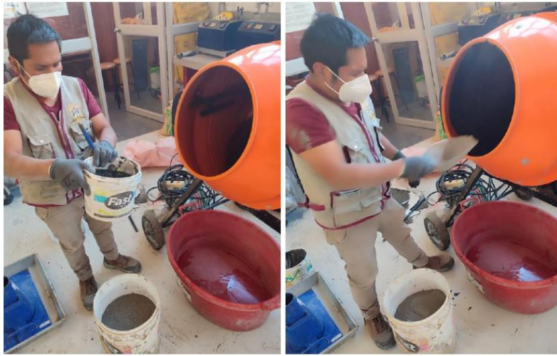
Sika Fume y Cemento Portland V – Concreto poroso en el laboratorio de la UNAT.
