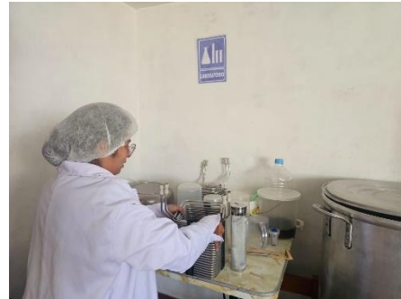
Sanitización de los equipos con StallerSan (1 ml/L) antes de iniciar la elaboración de la cerveza.
