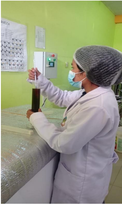
Cálculo de la densidad del mosto utilizando un densímetro.
