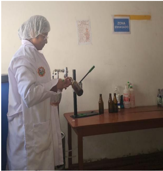
Proceso de embotellado y enchapado realizado rápidamente para evitar la entrada de oxígeno y el deterioro de la cerveza.
