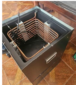
Proceso de enfriamiento del mosto con serpentín, utilizado para detener la formación adicional de DMS.
