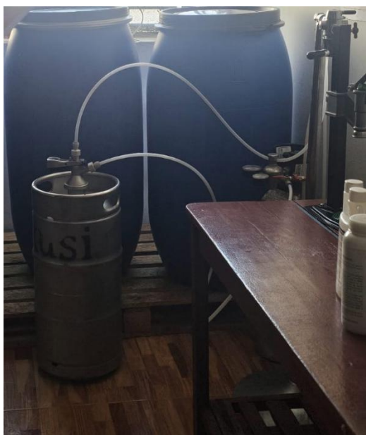
Proceso de filtración del mosto para retener partículas sólidas y mejorar la calidad del producto.
