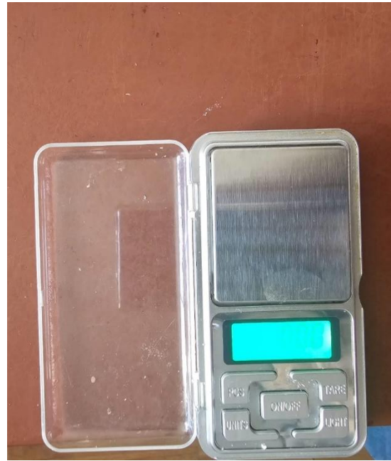
Uso de la balanza gramera para dosificar metabisulfito de potasio para el control de la fermentación.
